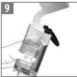
Remplissez de nouveau le réservoir d'eau avec la solution de détartrage usagée, collectée dans le récipient et répétez une fois l'étape 8.
