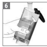
Rincez le réservoir d'eau avant de le remplir d'eau potable.
