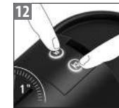
Pour sortir du mode détartrage, appuyez sur les deux boutons simultanément pendant une seconde. La machine est à présent prête à l'emploi.
