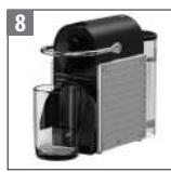
Placez un récipient sous l'orifice de sortie du café et appuyez sur le bouton Lungo pour rincer la machine. Répétez trois fois l'opération.
